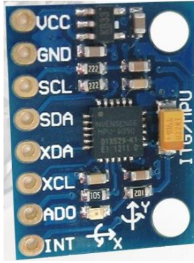
Ábra 2: Tehetetlenségi mérőegység – Inven Sense MPU-6050 giroszkópot és gyorsulásmérőt is tartalmaz
